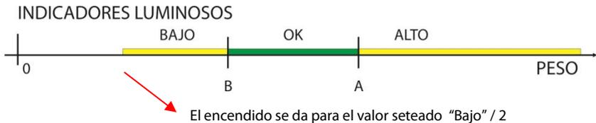
Al colocar el producto a clasificar sobre la balanza, y con el peso estable, el indicador clasifica el peso y activa el indicador luminoso correspondiente.
