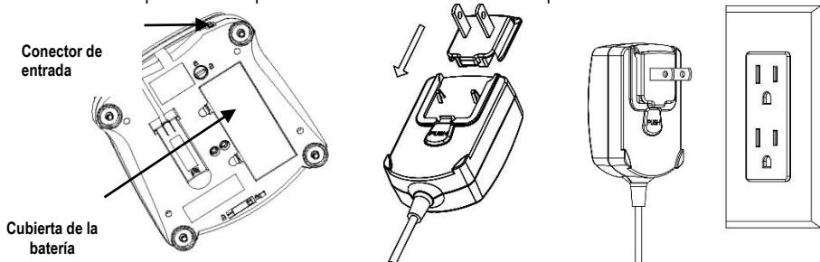
Conecte la toma del adaptador de CA en el conector de entrada.
