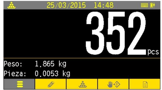
Adicionalmente se muestra en menor tamaño el peso neto sobre la plataforma y el peso por pieza ambos con la unidad correspondiente. El peso por pieza se muestra con un orden más de precisión que el peso.
