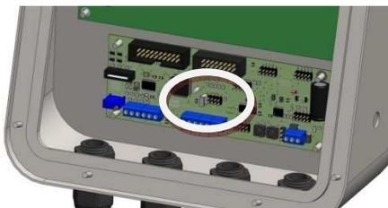
Desenergize y luego abra el equipo. Ubique el Conector H6 sobre la placa principal y coloque allí un jumper en la posición 1. Vuelva a ensamblar el indicador.
