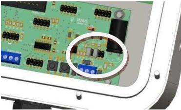
Para que el equipo permanezca siempre encendido deberá montar un JUMPER en la posición 3 del conector H1 de la placa principal del Controlador.
